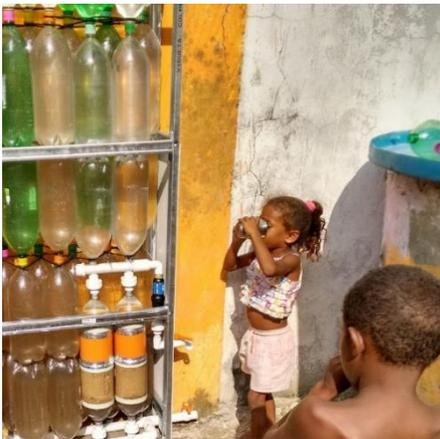
**Clorador:** para la obtención de agua potable se puede colocar un dispositivo clorador en la salida del agua, de este modo, el agua resultante es apta para consumo humano . Esta opción es utilizada mayormente en barrios de escasa infraestructura donde no llegan los sistemas tradicionales de abastecimiento de agua.
